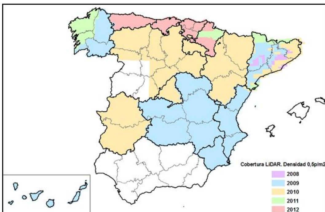
Figura 4.5. Cobertura LiDAR del Proyecto PNOA 2008-2012
