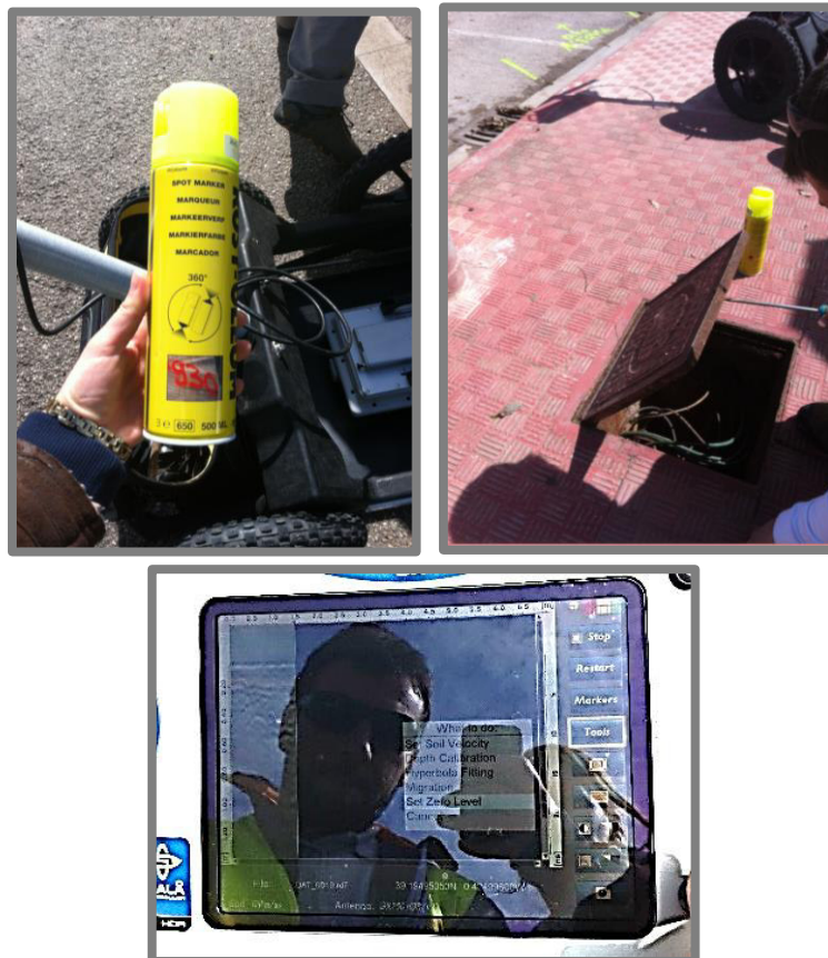
Ilustración N°18: Marcaje del servicio en el terreno y selección del Tiempo Cero de la Señal
