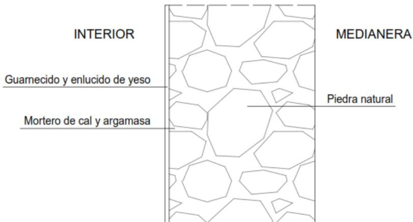
Figura 14. Sección muro zona seca - medianera
