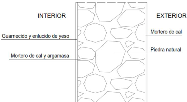
Figura 13. Sección muro zona seca - exterior
