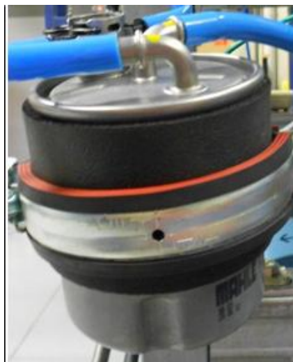
Figura 3. 8. Filtro de combustible
