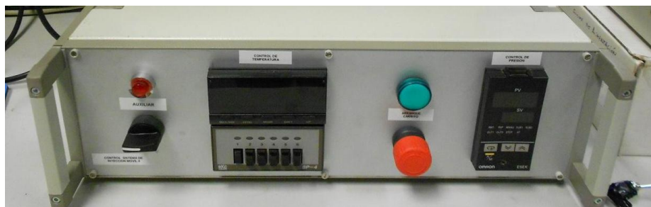
Figura 3. 14. PID y rack de temperaturas
