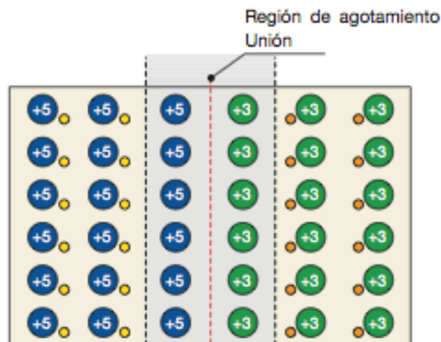
Figura 1. 7. Unión P-N (fuente: ABB)
