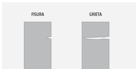
Ilustración 46. Diferencia entre fisura y grieta. 2015. hagaloustedmismo.cl
