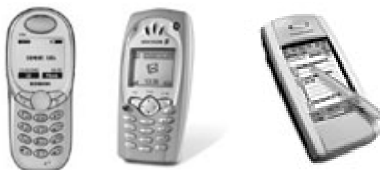
Figura 2.14: Ejemplos de terminales con antena integrada.
