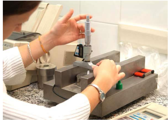
Ilustración 10: Micrómetro de interiores; sirve para medir las dimensiones interiores de un objeto con gran precisión y en un rango del orden de centésimas o de milésimas de milímetro.
