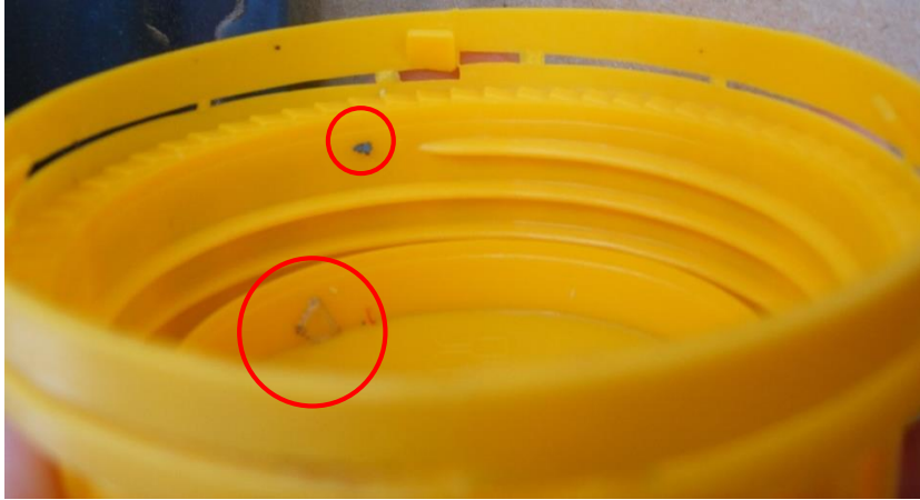
Ilustración 18: Pieza con suciedad
