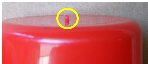
Ilustración 19: Pieza con punto de inyección alto
