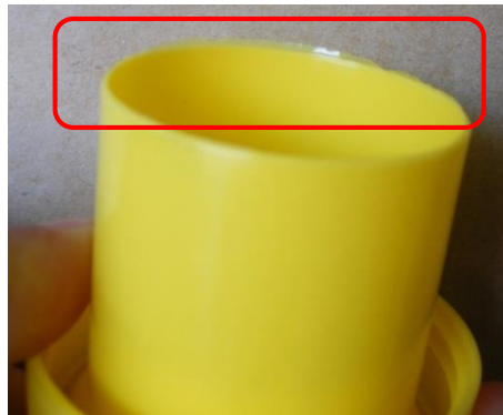
Ilustración 15: Pieza con rebaba
