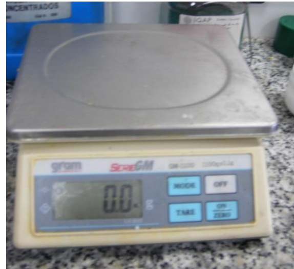
Ilustración 12: Báscula utilizada para contrastar que los productos cumplen con los requisitos y especificaciones de peso
