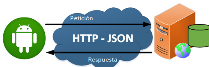
Figura 3. 12.- Transmisión de datos entre terminal Android - Servidor Web.
