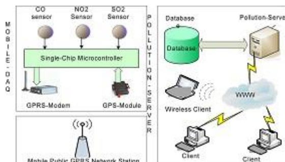
Figura 2. 6.- Monitorización a través de un Sensor Móvil GPRS.
