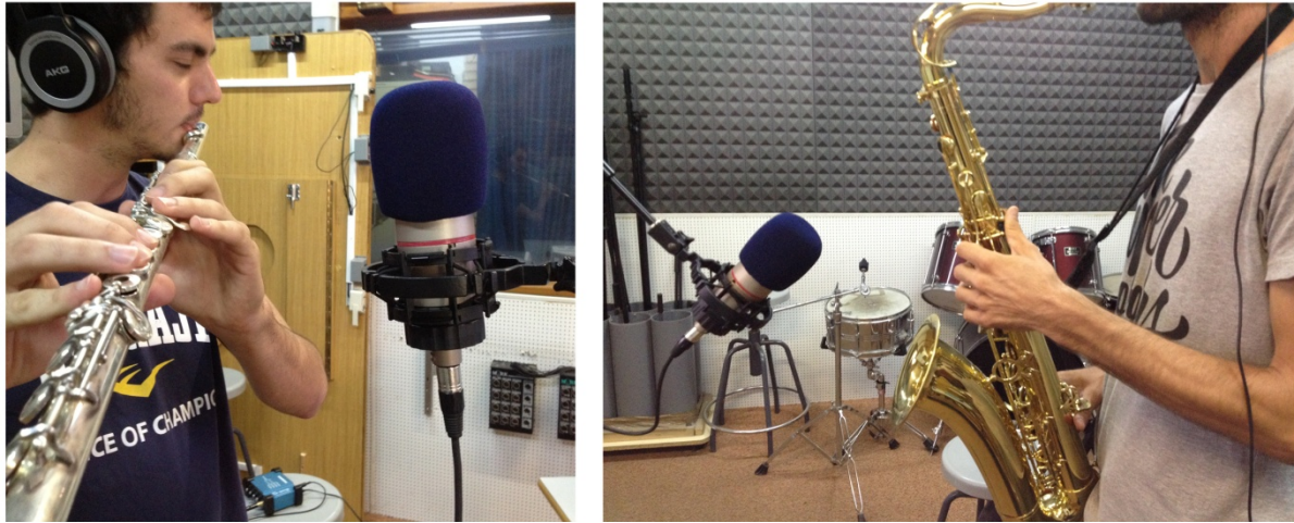
Ilustración 27. Toma de sonido de la flauta (izquierda) y del saxofón con el micrófono AKG C4000B.
