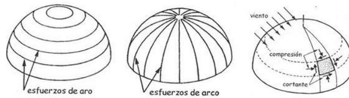
FIG 2.9. COMPORTAMIENTO DE LAS CÚPULAS
