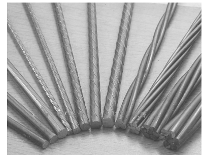
FIG. 4.48. BARRAS DE PRETENSADO Y CORDONES
