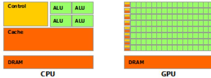
Figura 2.1: Arquitecturas generales de CPU y GPU
