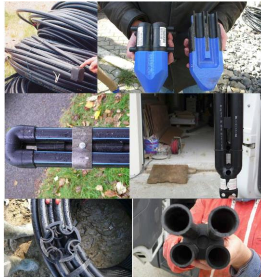
Figura 3.8: Pies de sondas geotérmicas y espaciadores. (Fuente: BRGM).
