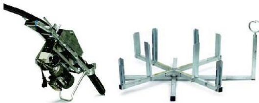
Figura 3.9: Mecanismos para realizar la bajada de sonda al interior del pozo de forma manual.
