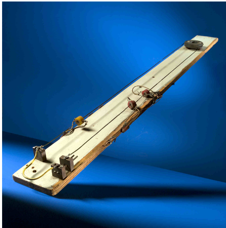
Figura 3.6: Prototipo de memoria construida para el desarrollo de la PROGRAMMA 101. 2
