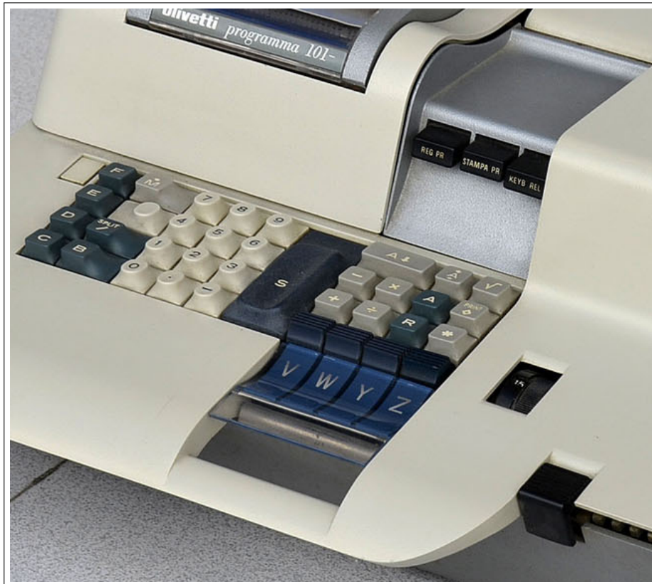
Figura 3.11: Diseño del teclado y del lector/grabador de tarjetas magnéticas de la PROGRAMMA 101.
