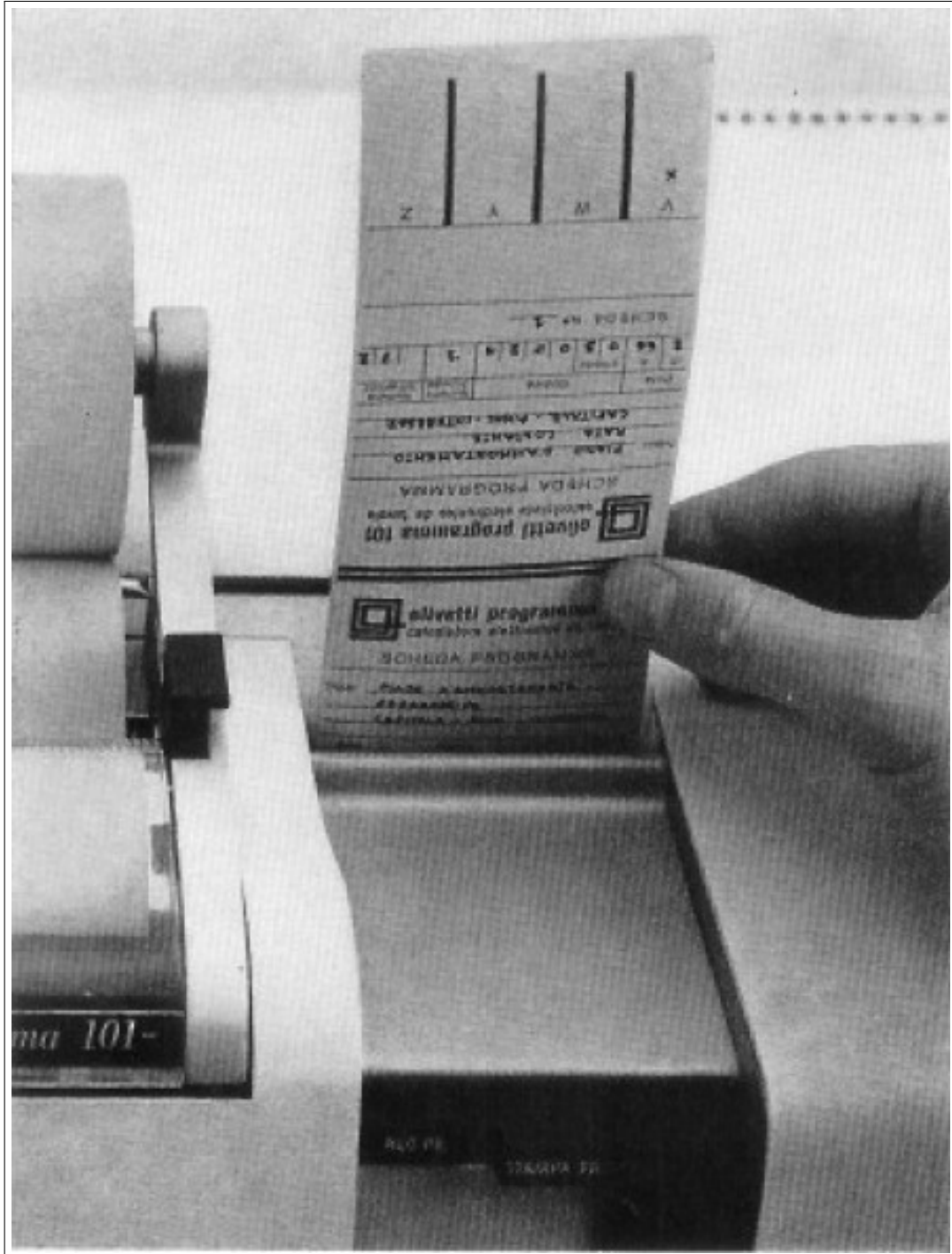
Figura 3.9: Modo de utilización de la tarjeta magnética [16].
