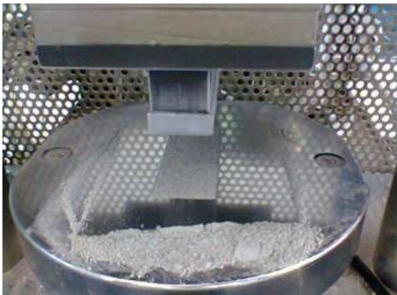
*Figura 5: Prensa compactando una probeta*
