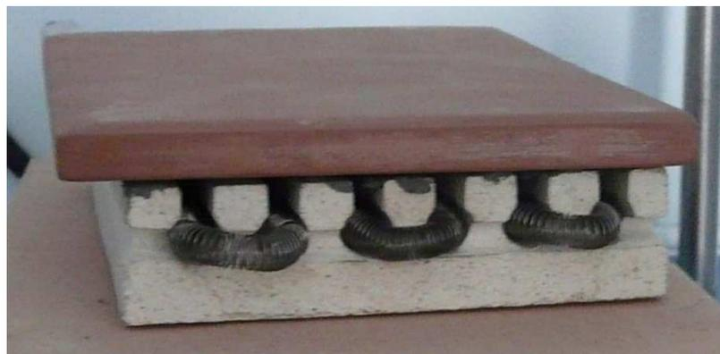
*Figura 19: Acumulador cerámico colocado sobre el soporte y la resistencia.*
