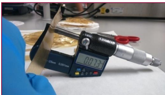
Figura 3-6 Medición de los espesores con el micrómetro electrónico digital.
