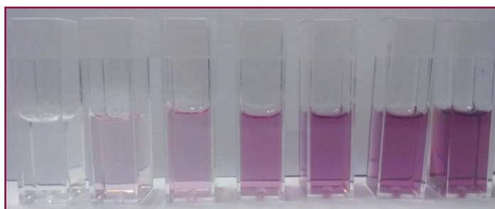
Figura 4-2 Cubetas para la recta de calibrado del DPPH.
