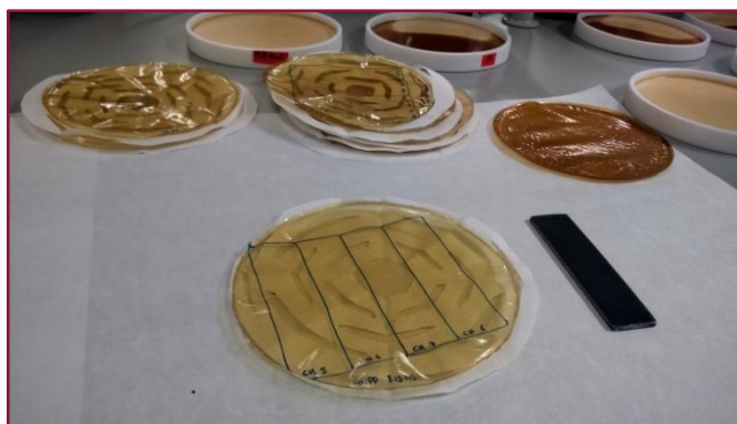
Figura 3-7 Preparación de las películas para el ensayo de mecánicas.
