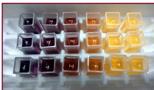
Figura 3-10 Ejemplo de la decoloración del DPPH• al reaccionar con el antioxidante.
