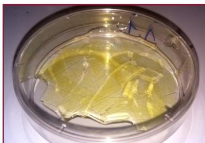
Figura 3-4 Película en placa Petri con agua para el ensayo de solubilidad.
