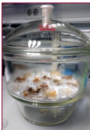
Figura 3-5 Desecador con pentóxido de fósforo con las placas Petri para el ensayo de solubilidad.
