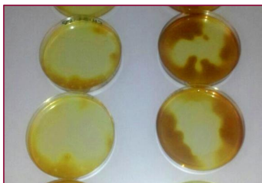
Figura 4-7 Películas de St y HPMC durante el proceso de la obtención del film donde se muestra las coloraciones adquiridas.
