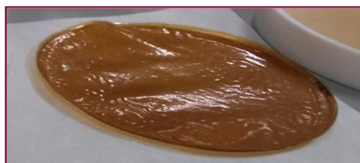
Figura 1-1 Película por casting húmedo de HPMC con incorporación de polifenoles.
