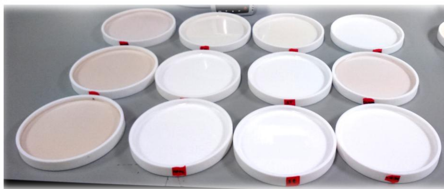
Figura 3-3 Dispersiones formadoras de películas en placas de teflón.
