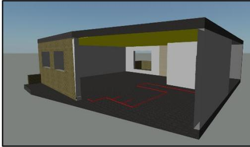
*Imagen 40. Fase 2, Instalación de fontanería. Año 2015. Fuente: Elaboración propia.*
