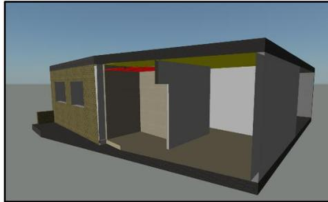
*Imagen 44. Fase 6, Colación placas del falso techo. Año 2015. Fuente: Elaboración propia.*
