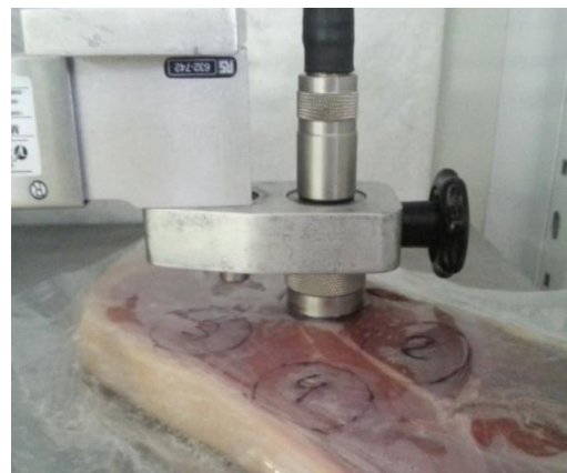
Figura 3.7. Imagen de la medida de US señal en el punto 1 del músculo Semimembranosus .
