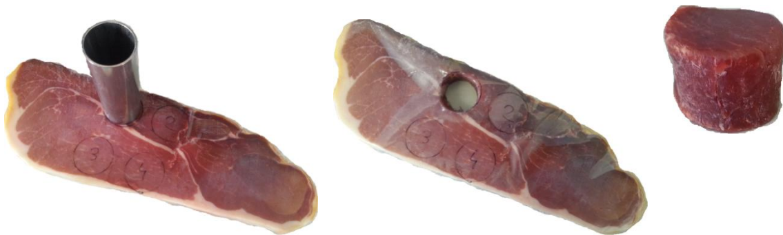
Figura 3.8. Obtención de las muestras cilíndricas de 2 cm de diámetro y 2 cm de altura.
