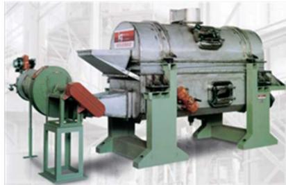
*Imagen 7: Secador de lecho fluidizado*
