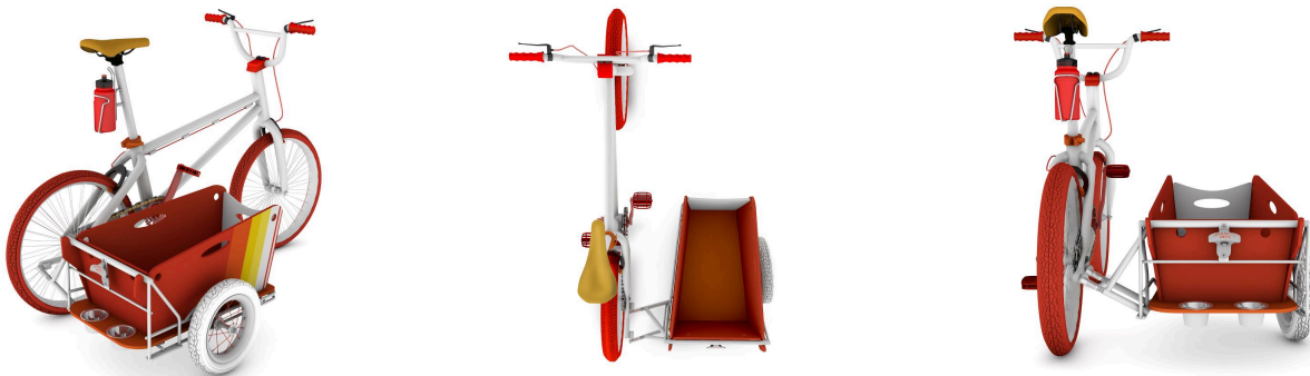
Figura 5.8. Sidecar a partir de una bicicleta.
