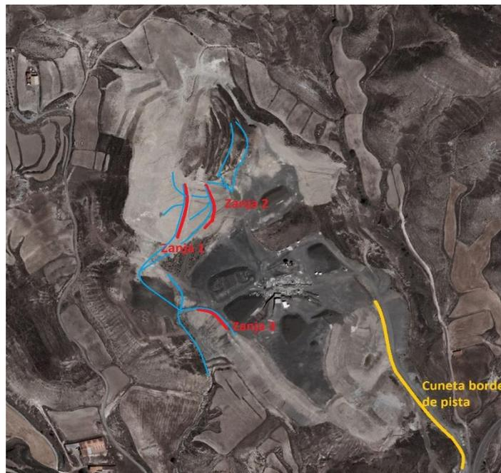
Figura 1. Localización de las zanjas y cuneta en la mina.
