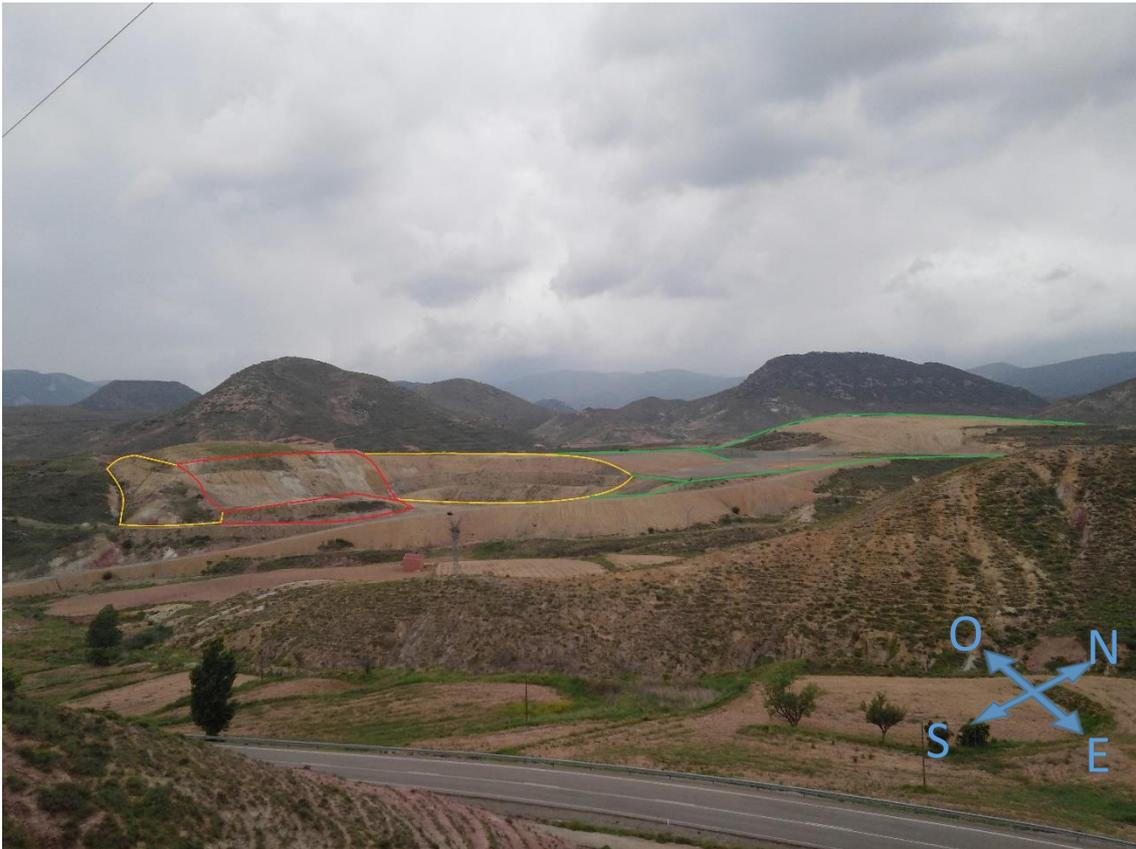
Figura 1. Zonas de la mina en función de la pendiente y accesibilidad a maquinaria. Vista desde el Este.
