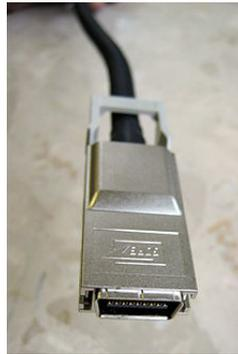
**Ilustración 7: Conector de enlace InfiniBand.**
