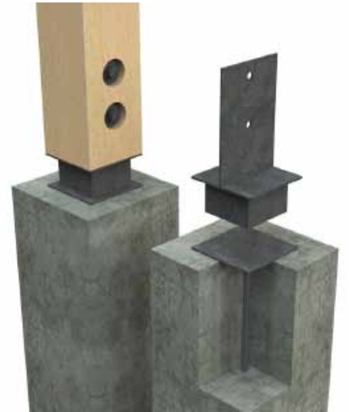
Tipo de unión para los pilares de madera de la cafetería. El anclaje es metálico y pero salvaguarda de humedad a la madera
