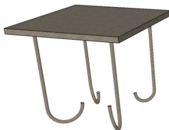
Figura 49: Esquema básico de la placa de anclaje a dimensionar
