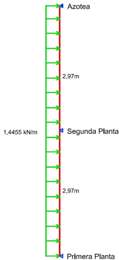
Figura 40: Carga de Viento sobre el pilar 4
