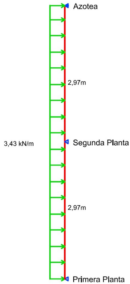
Figura 41: Carga de Viento sobre el pilar 8
