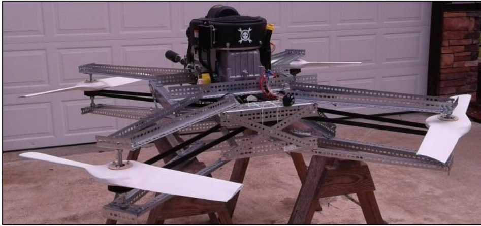
Ilustración 3. Dron casero propulsado con MCIÁ único unido a un sistema de correas
