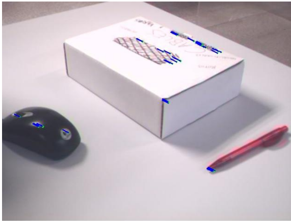
Ilustración 28. Flujo óptico con tamaño de ventana 10x10
