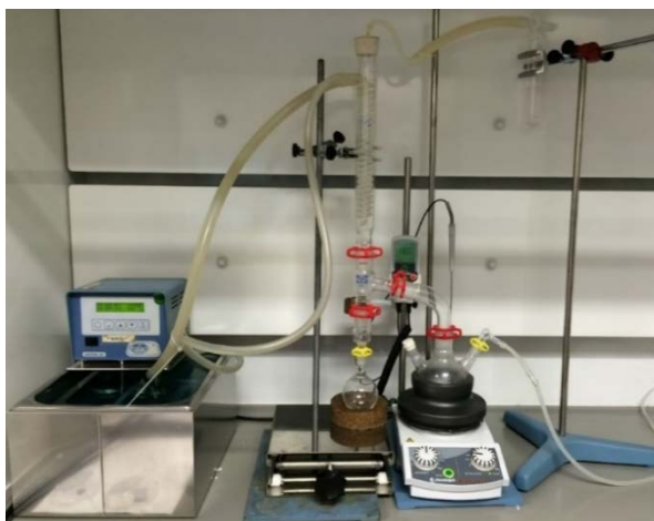
Figura 5. Montaje para la pre-polimerización de poli (glicerol sebacato).
