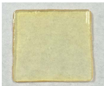
Figura 7. Film de PGS obtenido bajo condiciones estándar de síntesis.
