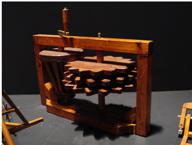
Figura 2.1. Cambio de velocidades de Leonardo da Vinci. (Fuente: www.transmisionmanualcvtis160.blogspot.com.es )
