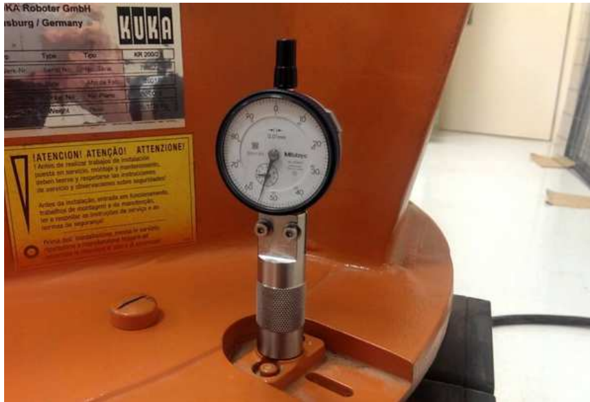
Figura 5.17. Punto de calibración
