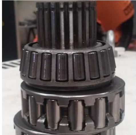
Figura 3.1. Eje con rodamiento de rodillos cónico y leva excéntrica con rodillos cilíndricos ( r=4\text{mm} )
