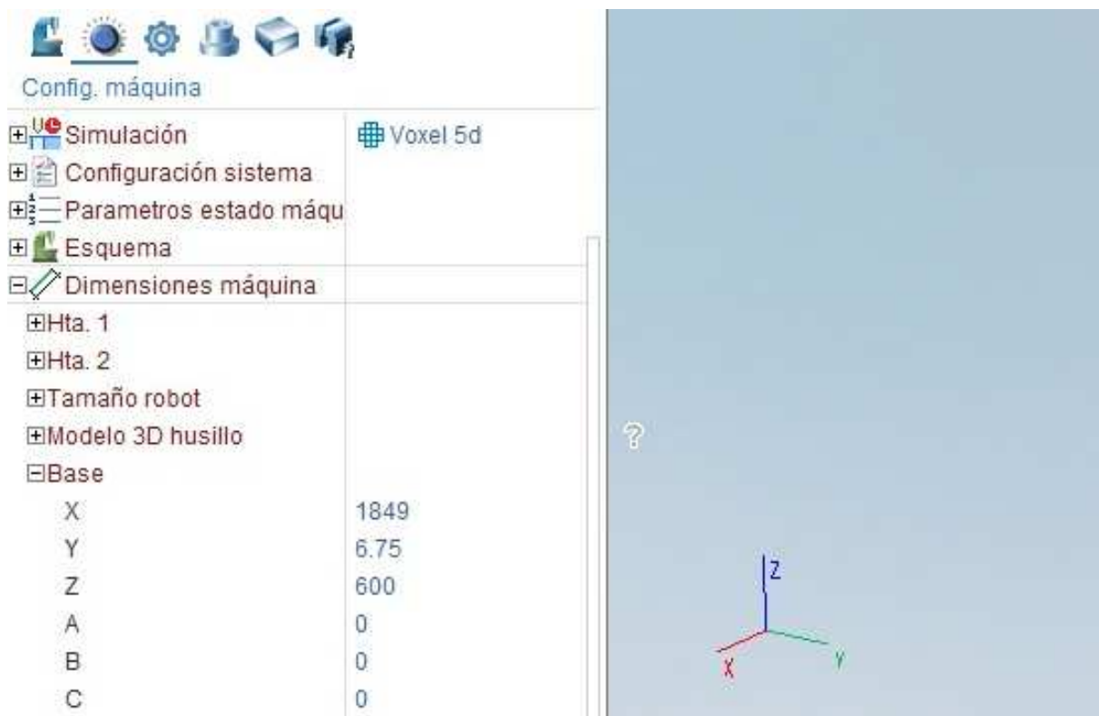
Figura 5.22. Introducción de la situación exacta del centro del eje externo
