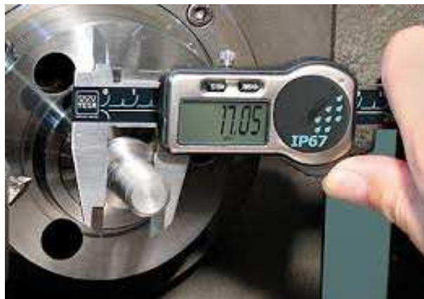
Figura 2.2. Medición con calibre digital
