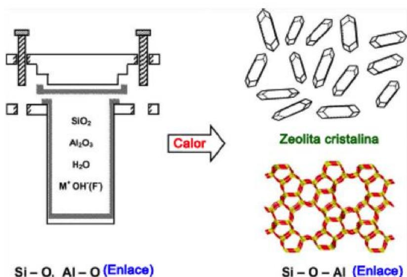
Figura 2. Esquema general de síntesis hidrotérmal de una zeolita
