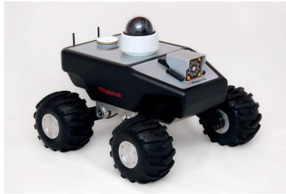
Figura 2.4.1.1: Robot rodante Summit XL con configuración 2+2 y tracción en las 4 ruedas
