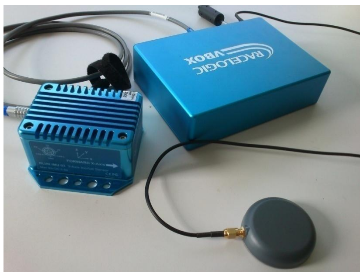
Figura 2.4.2.15: Dispositivo GPS con IMU y antena
