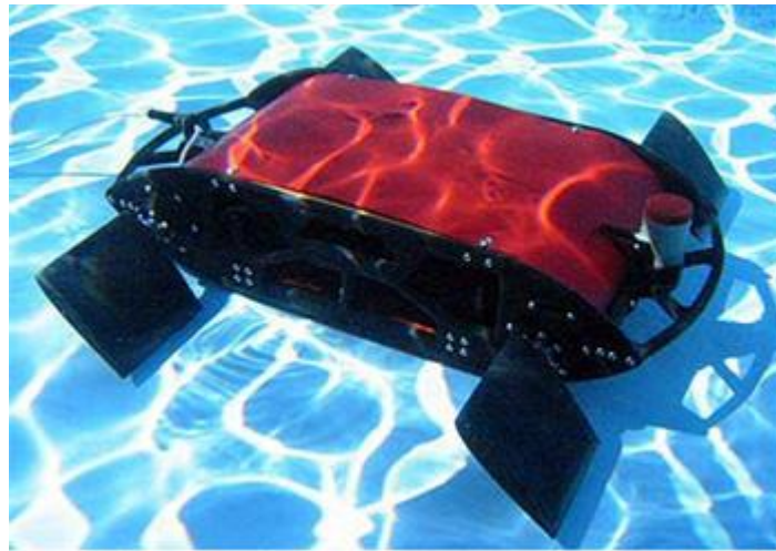
Figura 2.4.1.7: Robot Madeleine imitando el sistema de locomoción de animales marinos
