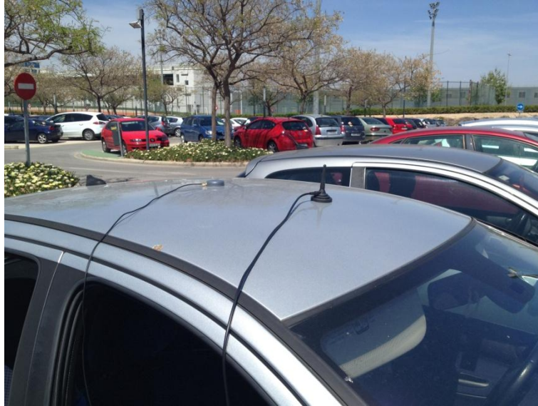
Figura 3.1.3.5: Antena GPS y antena DGPS encima del coche para la prueba
