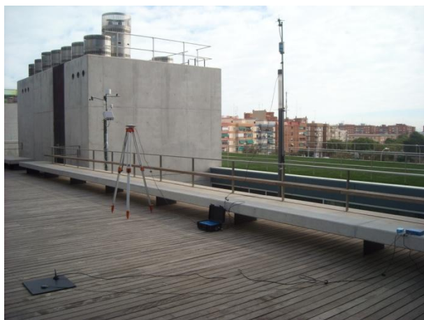
Figura 3.1.3.1: Área de pruebas con el VBOX3i y el DGPS montados
