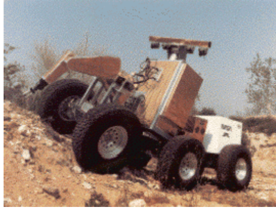
Figura 2.4.1.3: Robot rodante de 6 ruedas con independencia frontal y trasera
