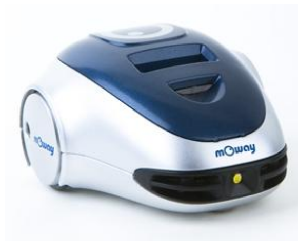
Figura 2.4.1.2: Robot rodante mOway en configuración triciclo con una rueda 'loca'
