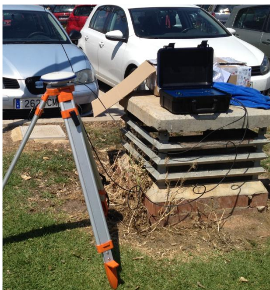
Figura 3.1.2.4: Estación base del DGPS con la antena GPS
