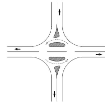
Figura n°07- Rotonda partida Tipo. Fuente: Guía de Nudos de Trazado. Ministerio de Fomento
