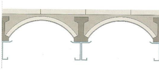
Ilustración 25 Refuerzo Sistema DIT 269.2009. (13)
