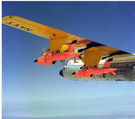
Figura 2.4: Drones FireBee a bordo de un DC-130
