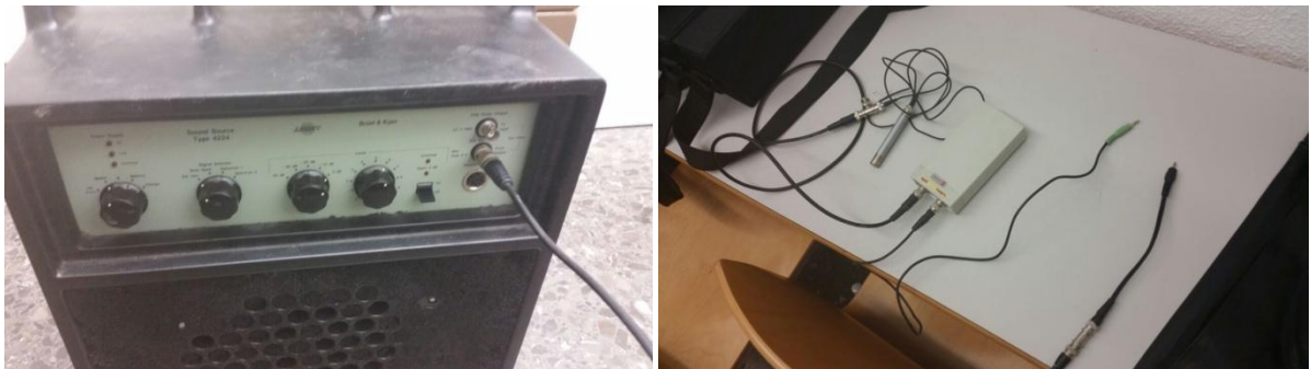
Figura 17 Altavoz y micrófono utilizados para realizar las mediciones de reverberación en la nave Fuente propia.
