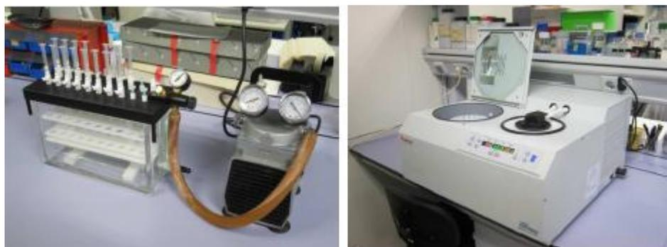
**Figura 7:** sistema de filtración SPE (izquierda) y Rotavapor (derecha)
