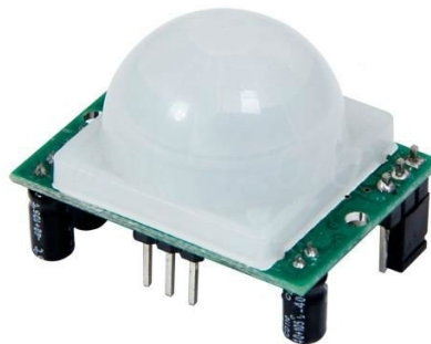
El módulo PIR HC-SR501, empleado como entrada de la aplicación
