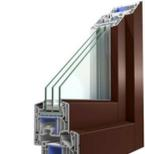
Los cristales de los huecos de fachada son dobles de climalit 4/6/4. Se van a substituir por climalit 4/12/4/12/4 con aislamiento térmico en una de sus caras, consistente en una capa metálica transparente e incolora. Además la tecnología coollite permite tener un control solar den los vidrios impidiendo que se sobrecalienten. Excesivamente.
