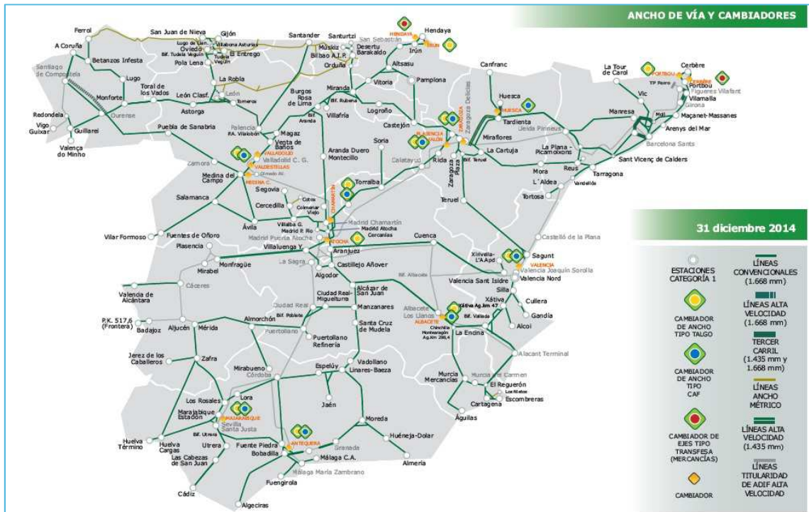
Figura E11: Mapa del tipo de ancho de vía y tipos de cambiadores en la red gestionada por ADIF. Diciembre 2014. (Fuente: Declaración sobre la red ADIF 2015).
