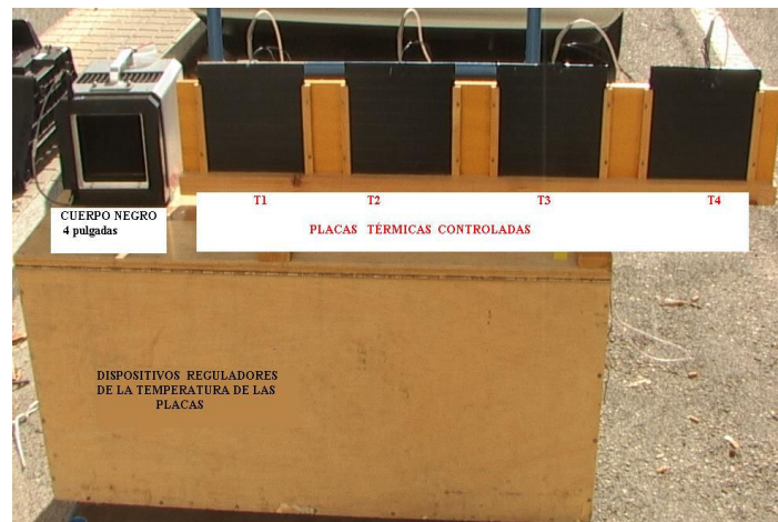
Fig. 3.5: Equipo de calibrado con placas térmicas en espectro visual.
