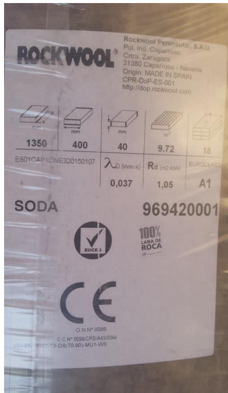
Imagen 3.64. Aislamiento de lana de roca para el interior del laminado de yeso
