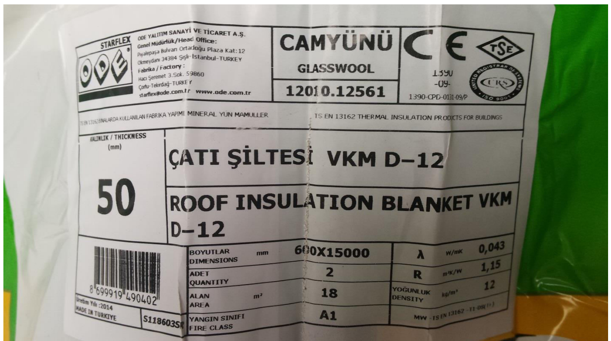
Imagen 4.2. Aislamiento de cubierta, Marcado CE
