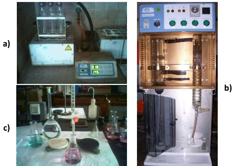
Figura 3.28. a) Digestor Kjeldahl. b) Destilador Tekator. c) Valoración de nitrógeno.
