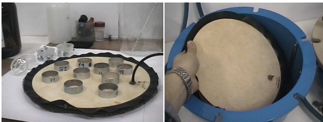
Figura 3.20. Detalle de colocación de las muestras en la cámara de Richards.
