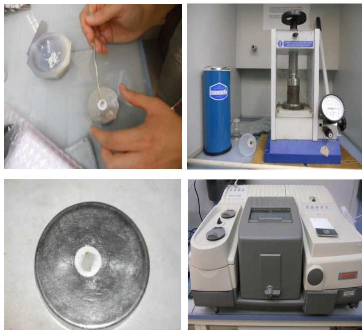
Figura 3.33. Preparación de la muestra. Prensa. Espectrofotómetro de IR.
