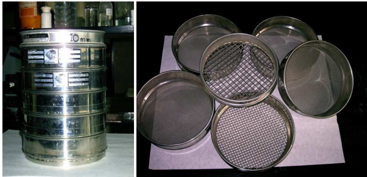
Figura 3.14. Batería de tamices utilizada en el tamizado en seco.
