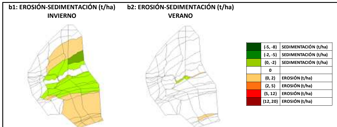
Figura 4.146. Representación cartográfica de los valores de erosión-sedimentación que se producen en la cuenca en las simulaciones realizadas con lluvia de Guadalest, escenarios b1 : invierno y b2 : verano.
