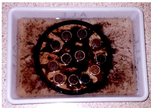
Figura 3.18. Anillos sobre placas porosas en las bandejas de humectación.
