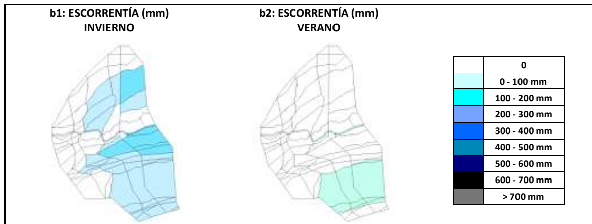
Figura 4.147. Representación cartográfica de los valores de escorrentía que se producen en la cuenca en las simulaciones realizadas con lluvia de Guadalest, escenarios b1 : invierno y b2 : verano.
