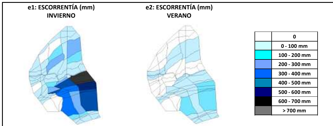
Figura 4.149. Representación cartográfica de los valores de escorrentía que se producen en la cuenca en las simulaciones realizadas con lluvia de Marina Baixa, escenarios e1 : invierno y e2 : verano.
