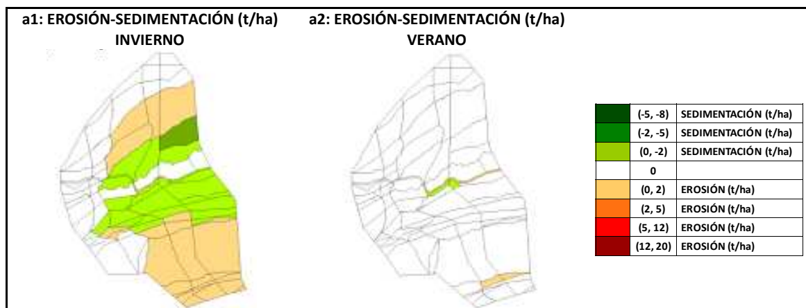
Figura 4.142. Representación cartográfica de los valores de erosión-sedimentación que se producen en la cuenca en las simulaciones realizadas con lluvia de Guadalest, escenarios a1 : invierno y a2 : verano.
