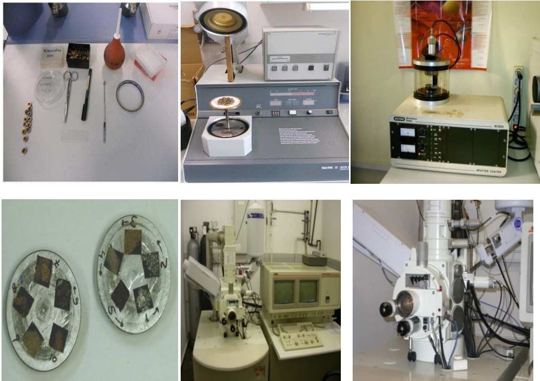
Figura 3.34. Preparación de las muestras. Sputtering . Microscopio electrónico de barrido HITACHI mod. S-4100 con cañón de emisión de campo, detector BSE ATRATA, sistema de captación de imágenes EMIP 3.0, y sistema de microanálisis RONTEC.
