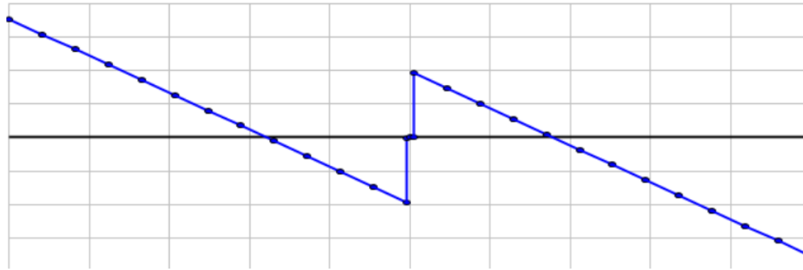
Fig. 79. Diagrama de momentos por el frenado respecto al eje horizontal.
