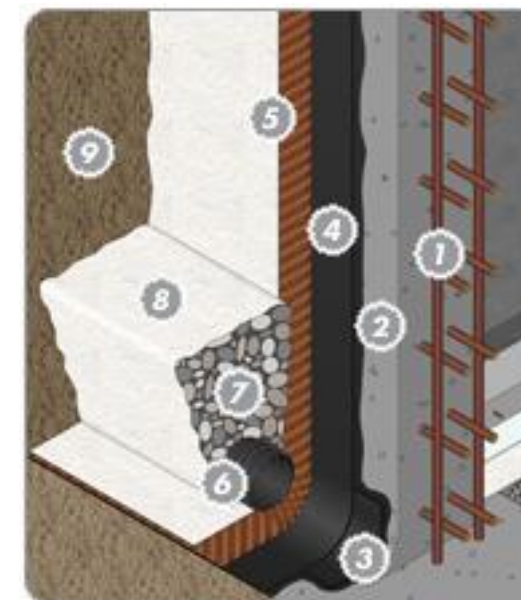
Fig. 40. Imagen de impermeabilización del muro.
