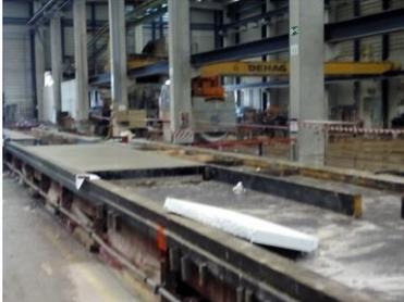
*Ilustración 26. Panel en fabricación.2015. Fuente: Propia*
