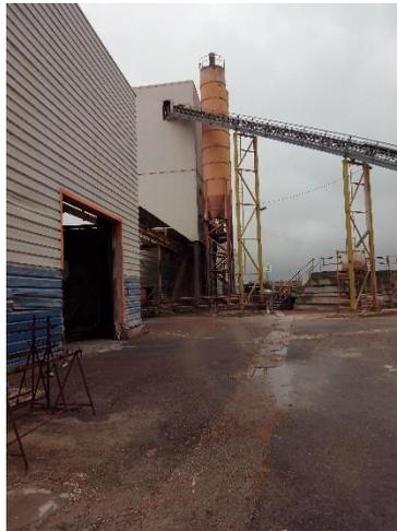
*Ilustración 23. Silo de almacenaje y cinta transportadora de materiales.2015.Fuente: Propia*
