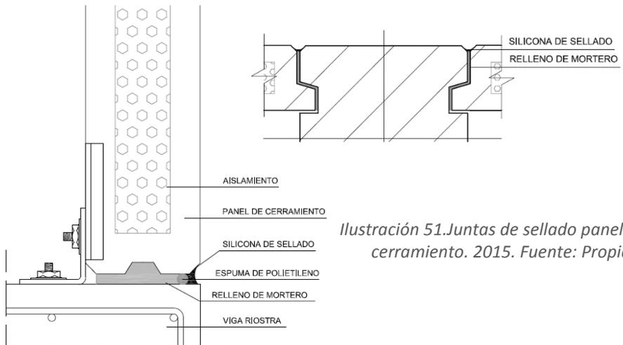
*Ilustración 51. Juntas de sellado paneles de cerramiento. 2015. Fuente: Propia*
