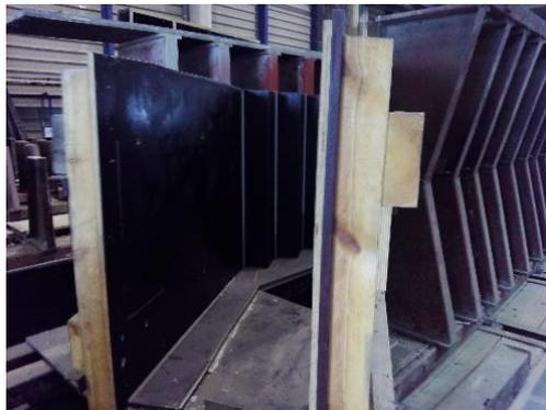
*Ilustración 22. Molde para escalera de madera fenólica.2015. Fuente: Propia*
