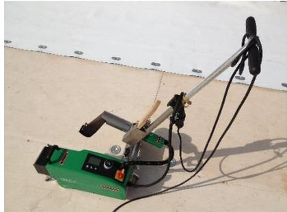
*Ilustración 71. Instrumento de fijación Impermeabilizante por calor. 2015. Fuente Propia*
