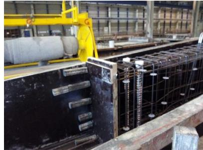
*Ilustración 34. Pista de encofrado para viga delta.2015. Fuente: Propia*
