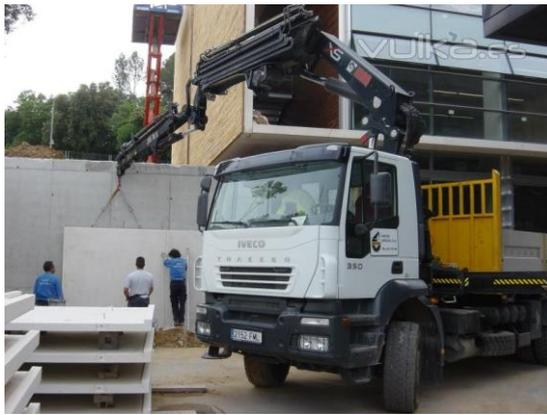
*Ilustración 88. Camión Autocargante. 2015. Fuente: Vulka*
