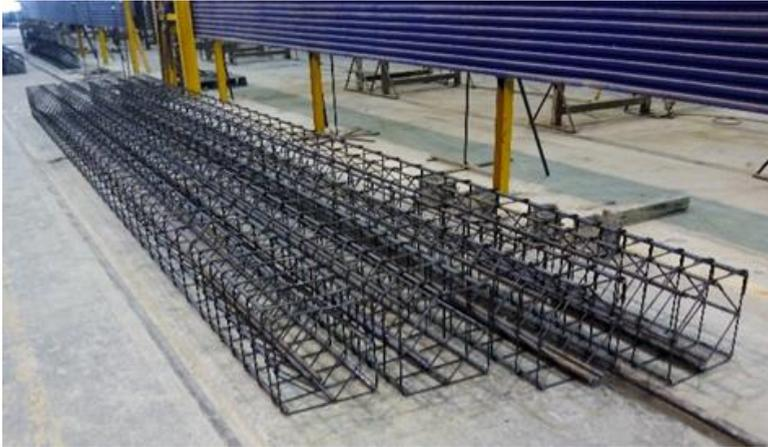
*Ilustración 6. Armaduras de pilares prefabricados.2015.Fuente: Propia*
