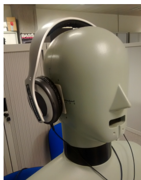
Figura 19 calibración de auriculares.
