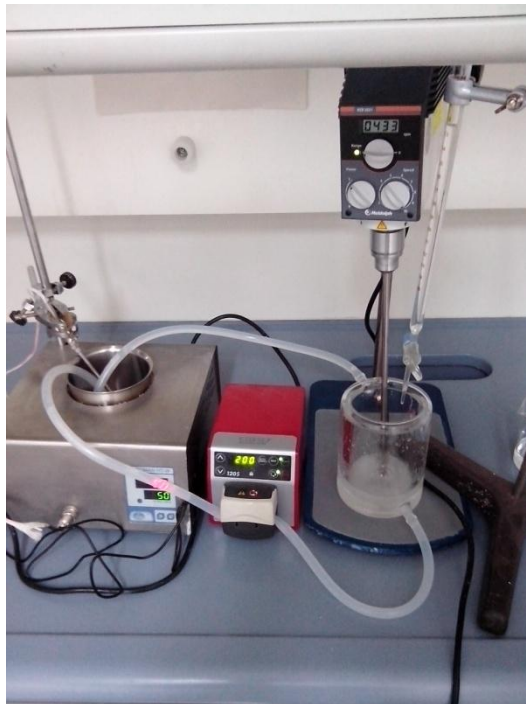
Figura II-1. Montaje del reactor.
