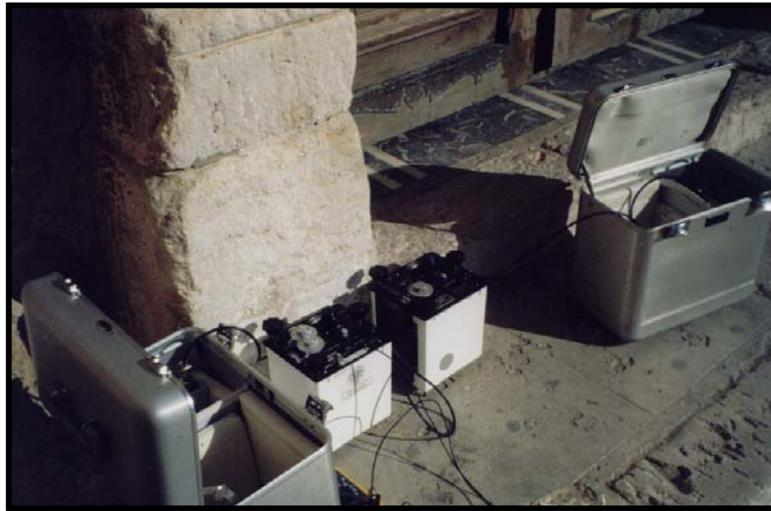
**Figura 5.12:** Metodología operativa de observación: toma de datos con los dos gravímetros a la vez.
