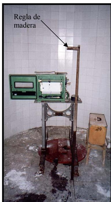
**Figura 3.1:** Regla de madera utilizada para las medidas del nivel del mar antiguamente.
