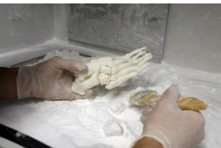
Fig. 52. Ejemplo de una pieza impresa por compactación, siendo extraída de la máquina.
