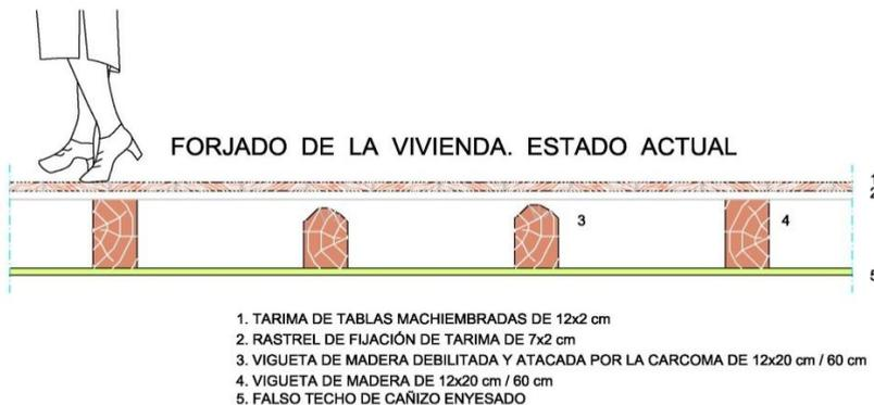
*Figura 41 Detalle forjado existente. Año 2015. Fuente: elaboración propia.*
