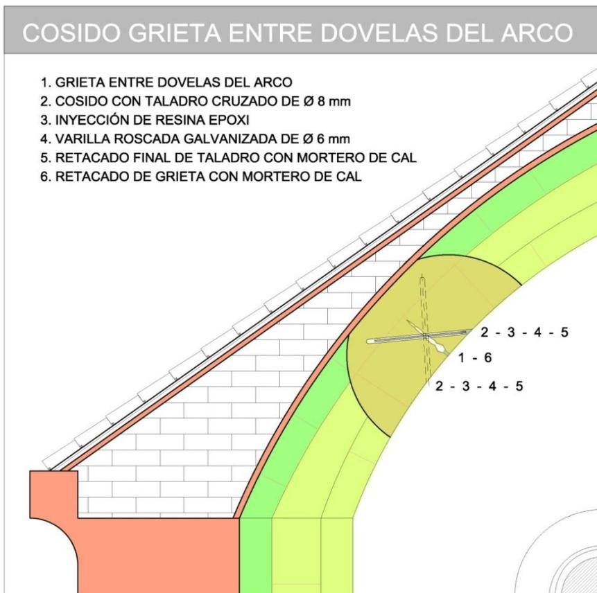
Figura 73 Detalle de cosido<sup>40</sup>. Año 2009. Fuente: elaboración propia
