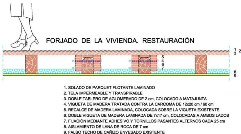
*Figura 46 Detalle propuesto para refuerzo de forjado. Año 2015. Fuente: elaboración propia.*
