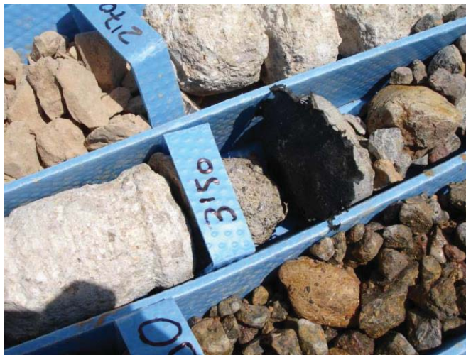
Figura 14: Lámina de PVC bajo la cimentación
